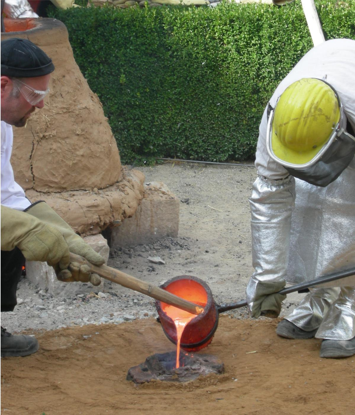
Abbildung 18: Guss der Glocke.
