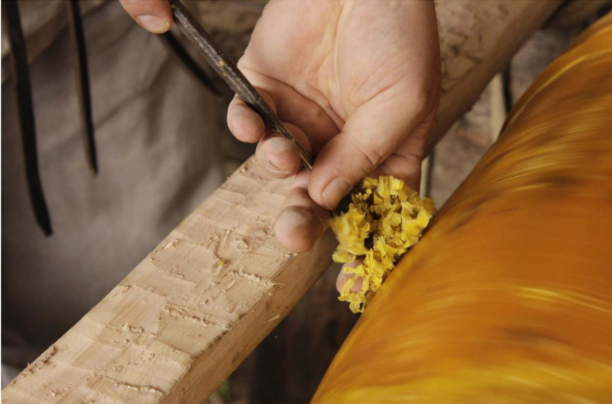
Abbildung 6: Abdrehen des Wachsmodells auf der Drehlade.
