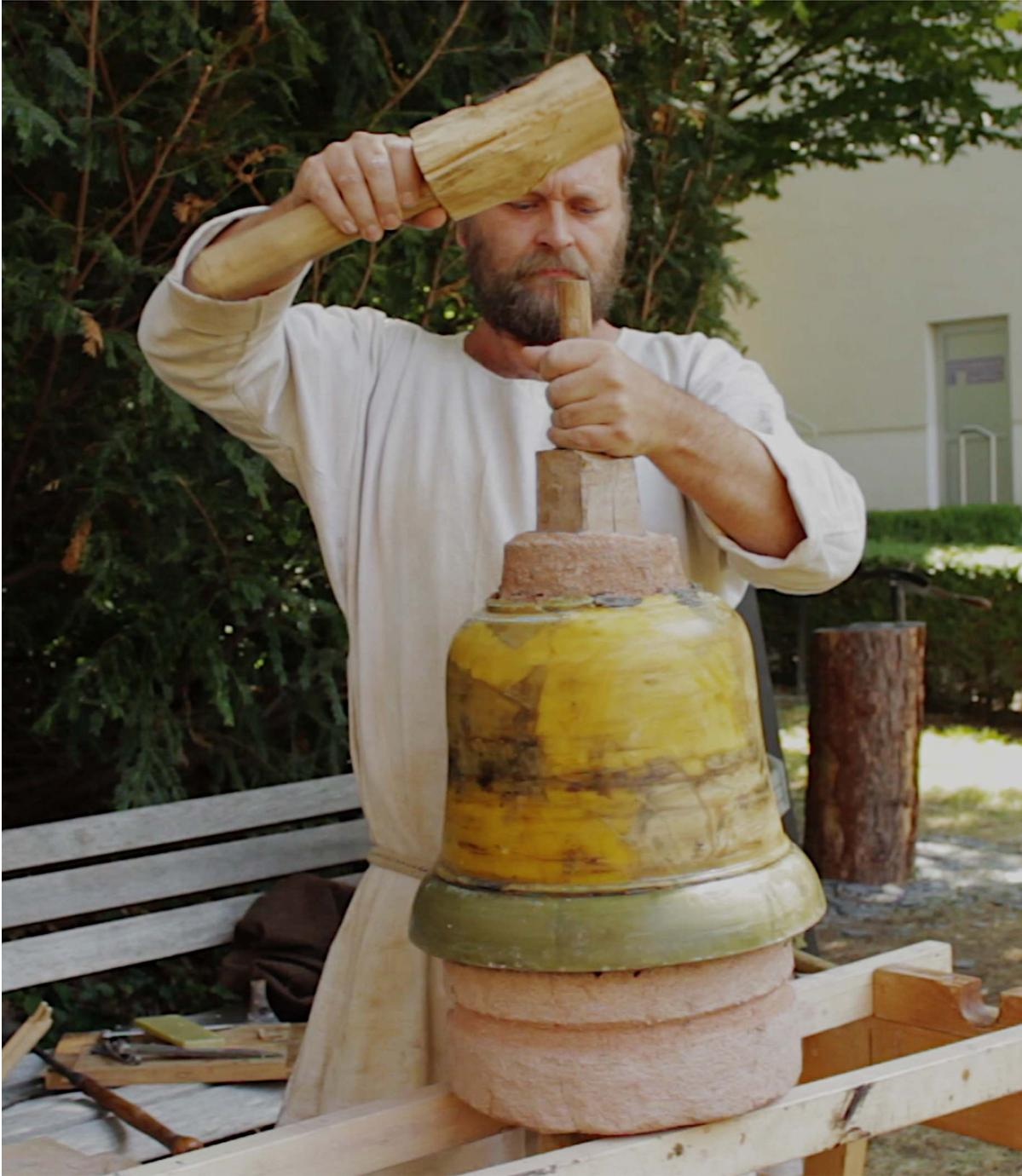
Abbildung 8: Entnahme der Spindel aus dem Glockenmodell.
