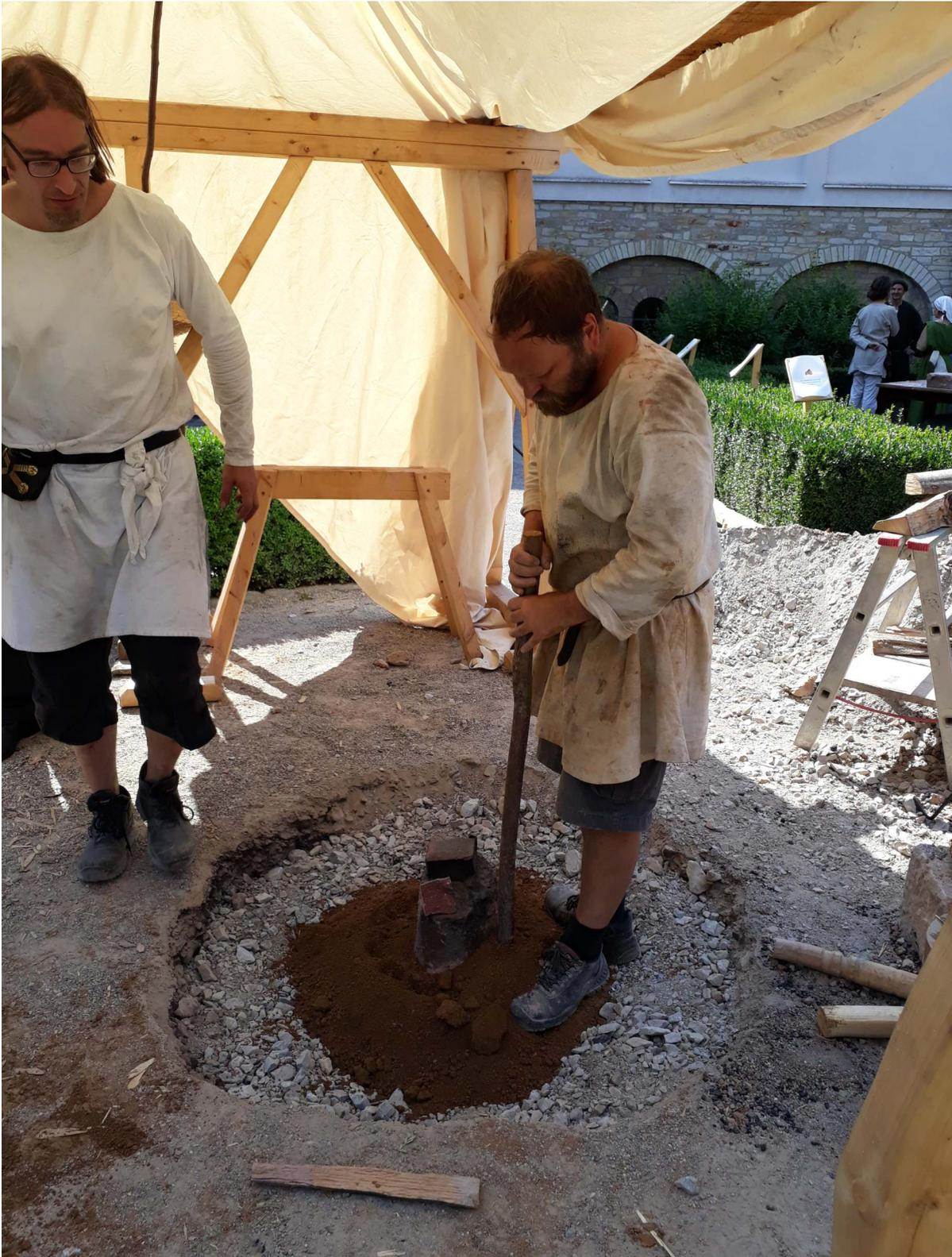
Abbildung 17: Die Glockenform wird in der Dammgrube verdämmt.
