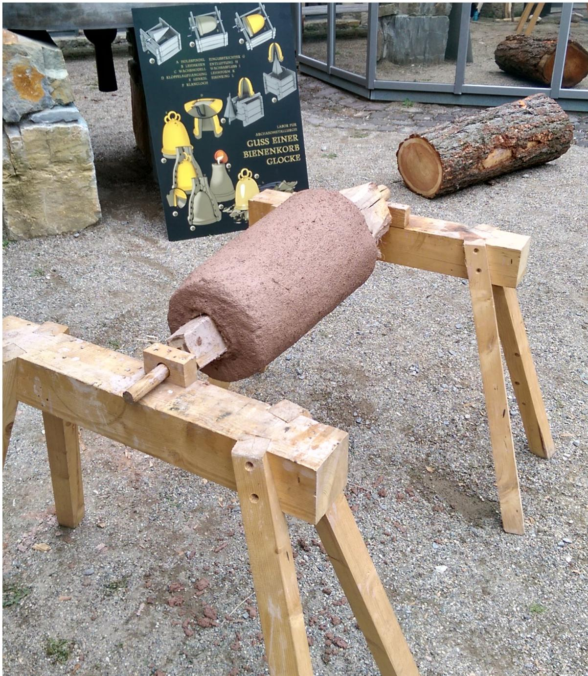
Abbildung 1: Der Arbeitsplatz mit der Drehlade und der Spindel. Hier mit angefangenem Lehmkern.
