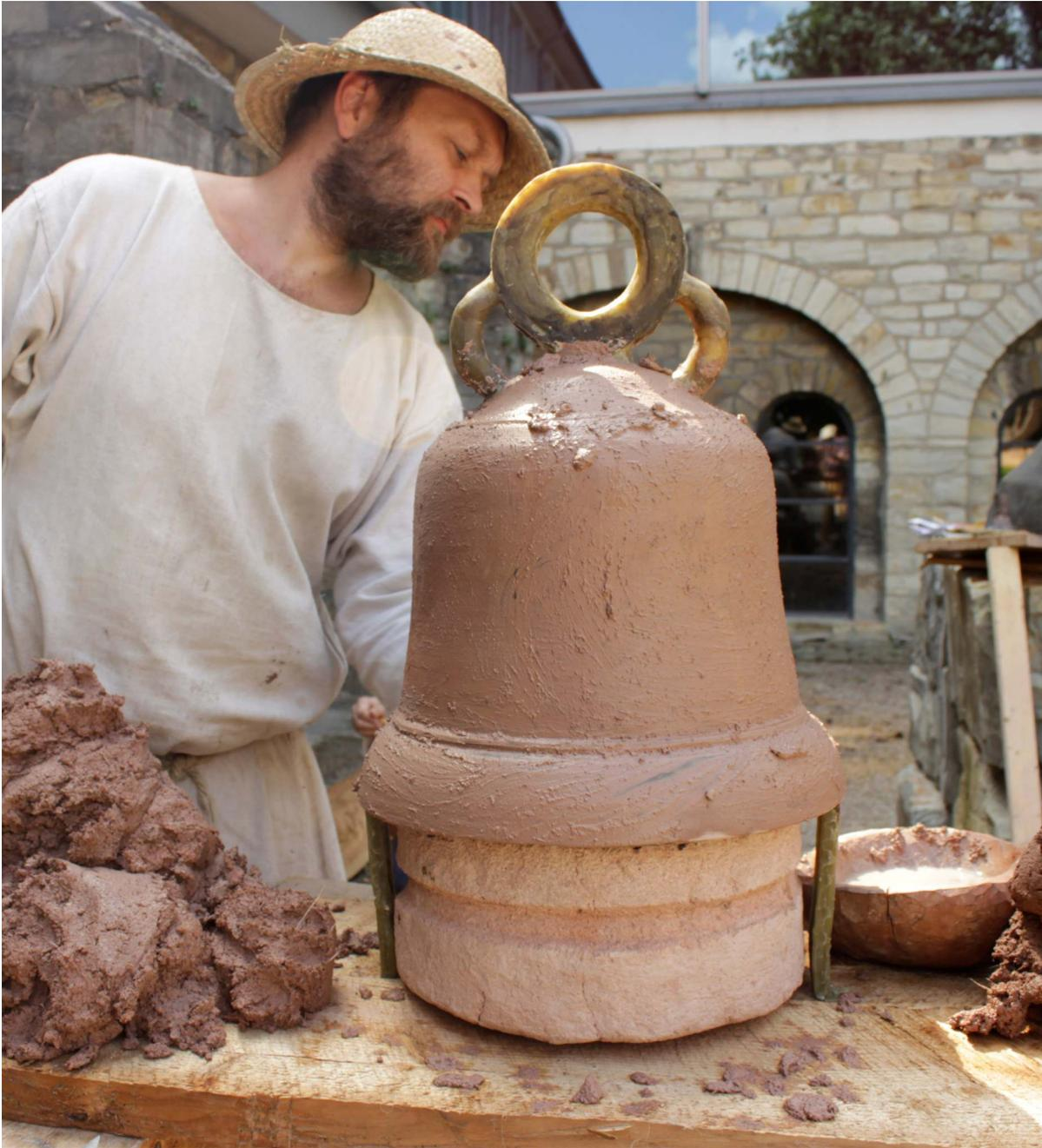
Abbildung 13: Erste Lehmschicht aus Schlichtlehm wird aufgetragen.
