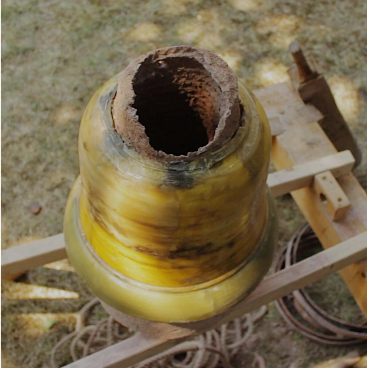
Abbildung 9: Das von der Spindel herrührende Loch wird nun mit Lehm aufgefüllt und die Aufhängung für den Klöppel eingefügt.
