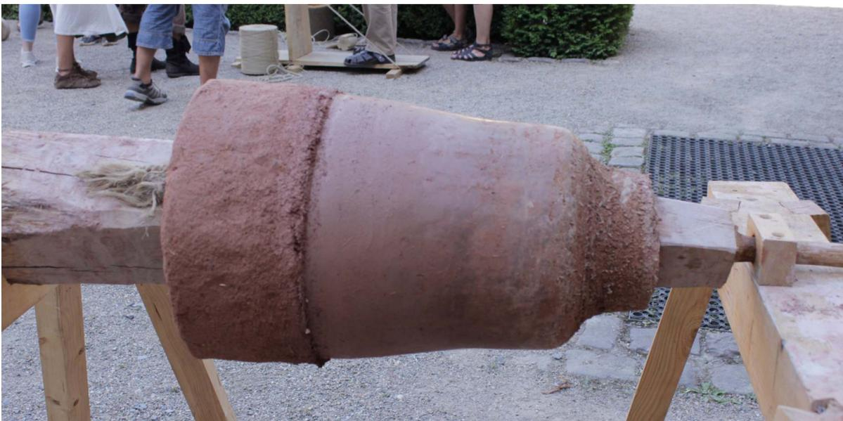
Abbildung 3: Der fertig gedrehte Lehm kern.
